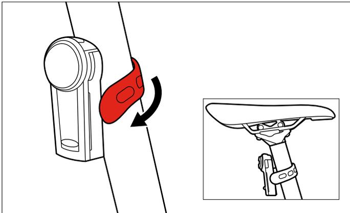
Befestigen Sie das Gummi um die Sattelstütze (Durchmesser 15 bis 45 mm).
