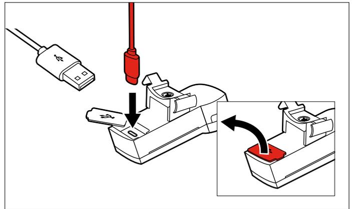
Öffnen Sie die Klappe und stecken Sie das USB-Kabel ein (die LED in der Taste gibt dabei den Ladestand an).
