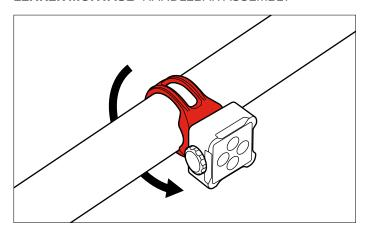
Befestigen Sie das Gummi um den Lenker (Durchmesser 31,8 bis 35 mm). Fit the strap around the handlebar (diameter 31,8 to 35 mm).
