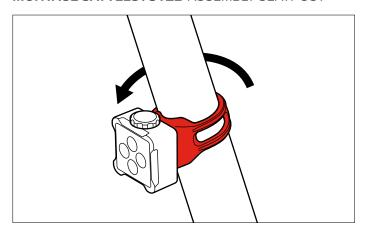
Befestigen Sie das Gummi um die Sattelstütze (Durchmesser 22 bis 35 mm). Fit the strap around the seat post (diameter 22 to 35 mm).
