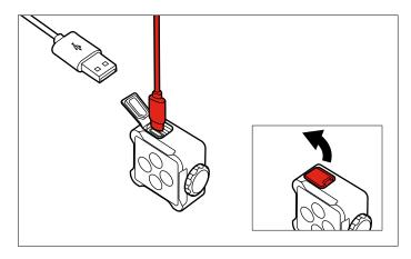
Öffnen Sie die Klappe, stecken Sie das USB-Kabel ein. Schließen Sie das USB-Kabel an eine Stromquelle (max. 5 Volt) an. Die Anzeige leuchtet grün, wenn sie geladen wird, und geht aus, wenn sie geladen ist.
