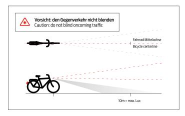
Richten Sie die Leuchte auf die Mittelachse des Fahrrads aus. Align the light with the center axis of the bike.
