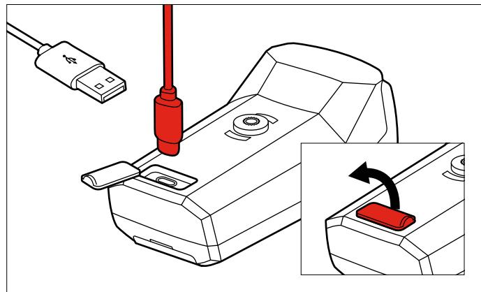
Öffnen Sie die Klappe und stecken Sie das USB-C-Kabel ein (die LED in der Taste gibt dabei den Ladestand an).
