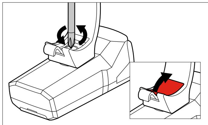
Entfernen Sie das Schutzgummi und lösen Sie die Halterung mit einem Kreuzschraubendreher.
