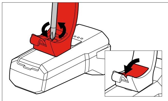
Befestigen Sie die Halterung an der Oberseite mit einem Kreuzschraubendreher und bringen Sie das Schutzgummi wieder an.
