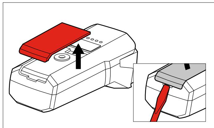
Lösen Sie die Abdeckung vorsichtig mit einem flachen Schraubendreher.
