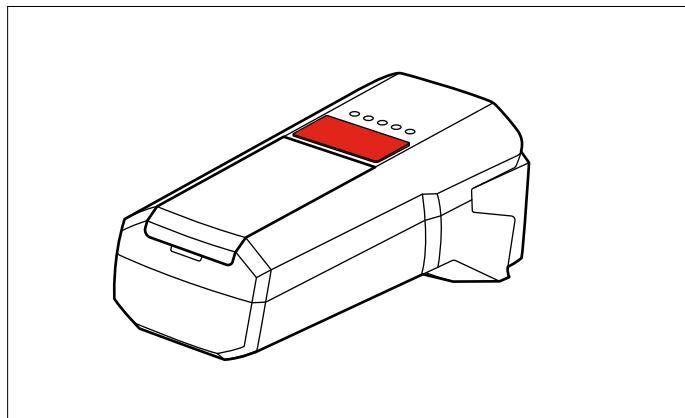
Halten Sie die Taste gedrückt, um das Licht ein- oder auszuschalten. Drücken Sie kurz auf die Taste, um zwischen den Lichtmodi (10, 40 oder 80 Lux) und 3 Blinkermodi (Tageslicht, Nachtlicht und Stromspar Pulsieren) zu wechseln.
