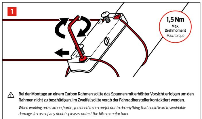
**1** Führen Sie die Kabel durch die Schlitze, spannen Sie diese mit der Hand und ziehen Sie die äußeren Schrauben fest.
