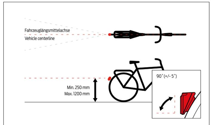
Richten Sie die Leuchte auf die Mittelachse des Fahrrads aus.
