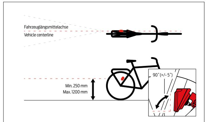
Richten Sie die Leuchte auf die Mittelachse des Fahrrads aus.
