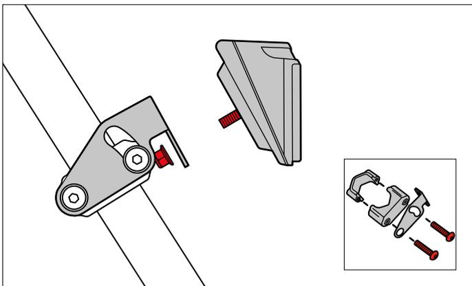
Das Rücklicht muss mit der mitgelieferten Halterung an der hinteren Stütze fest montiert werden.
