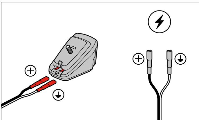
Verbinden Sie das mitgelieferte Kabel mit der Leuchte und dem Dynamo (6V).
