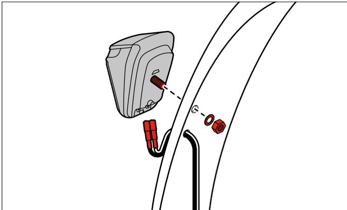
Die Rückleuchte muss fest an den vorgefertigten, standardisierten Bohrungen im Schutzblech angebracht werden.
