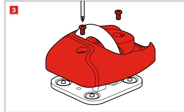
**3** Decken Sie den Anker mit dem Kunststoffteil ab und befestigen Sie ihn mit den 2 Schrauben. Cover the anchor with the plastic part and secure it with the 2 screws.
