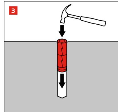
**3** Hämmern Sie die Stahldübel in die Löcher. Hammer the steel dowels into the holes.
