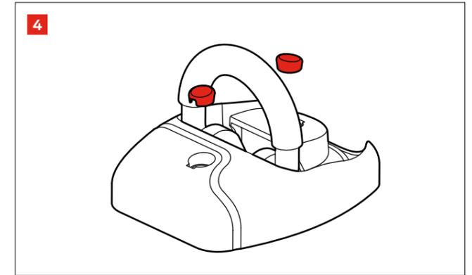
**4** Decken Sie die Schrauben mit den Kunststoffkappen ab. Cover the screws with the plastic caps.
