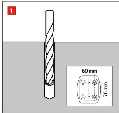
**1** Verwenden Sie die Schablone und bohren Sie  $\varnothing 16$  mm im Durchmesser und 70 mm tief. Use the template and drill  $\varnothing 16$  mm in diameter and 70 mm deep.
