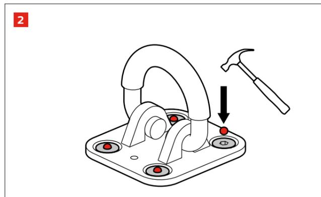
**2** Schlagen Sie die Metallkugeln in die Bolzen ein. Slam the metal balls into the bolts.
