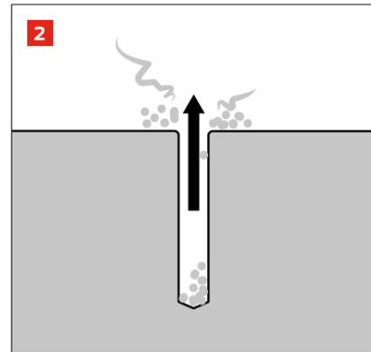
**2** Entfernen Sie die Ablagerungen. Remove the debris.
