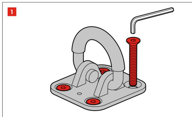
**1** Drehen Sie die Schrauben mit einem Inbusschlüssel fest. Tighten the bolts with an Allen key.
