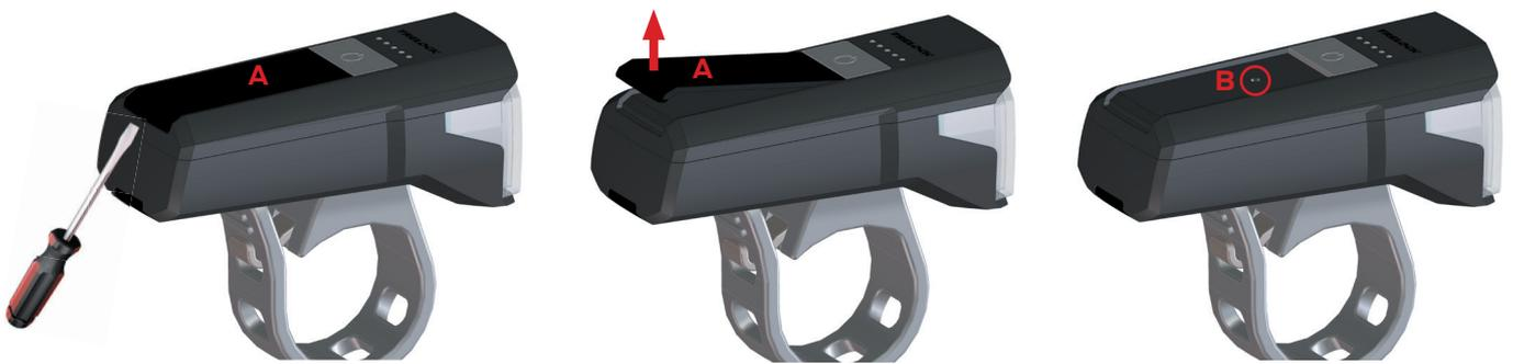
Einen kleinen Schlitz-Schraubenzieher in die Vertiefung stecken und die Blende (A) vorsichtig nach oben heraushebeln. Die Blende (A) kann nun vollständig entnommen werden und der Schraubpunkt (B) für den Halter wird freigelegt. / Insert a small flathead screwdriver into the cavity and carefully lever the cover (A) upwards. The cover (A) can now be completely removed and the mounting point (B) for the bracket is exposed.
