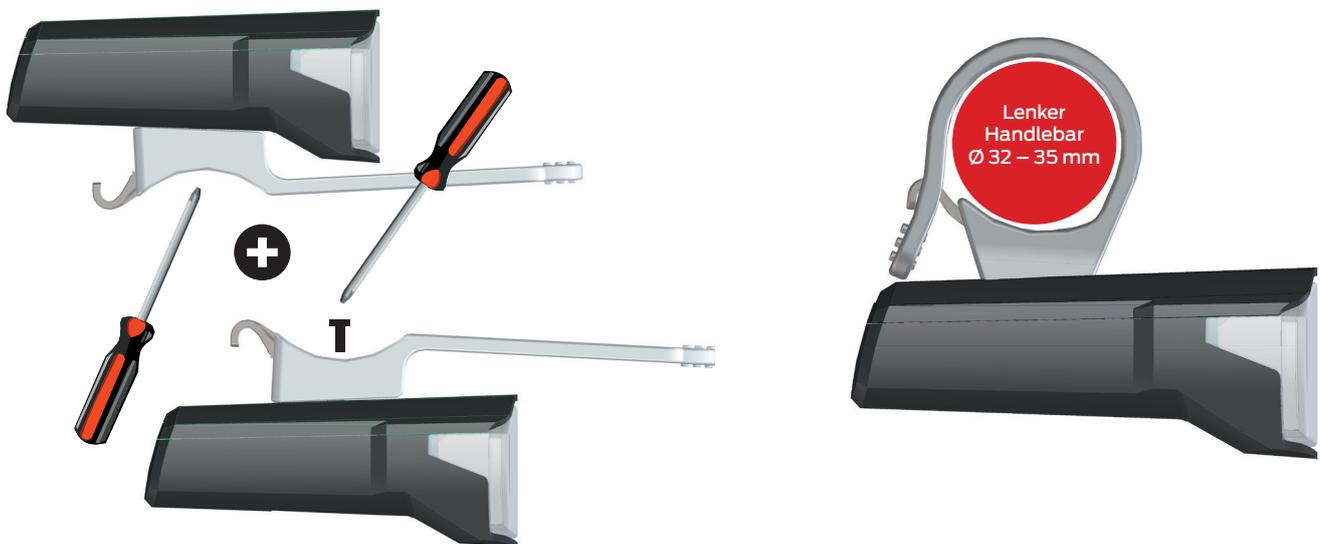
Mit einem Kreuzschraubenzieher den Halter unter der Lampe lösen und oben am Schraubpunkt (B) mit er selben Schraube wieder anschrauben. / Use a Phillips screwdriver to loosen the bracket under the lamp and screw it back on at the top screw point (B) with the same screw.
