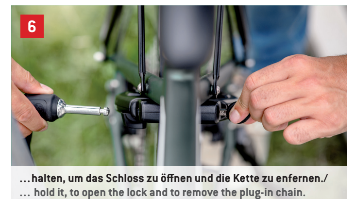
Schließbolzen einführen / Insert locking pin
