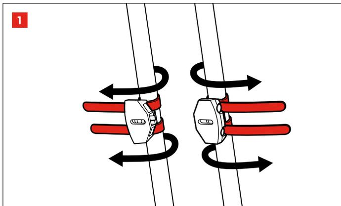
**1** Entfernen Sie die Kunststoffschrauben und befestigen Sie die Enden um den Rahmen.
