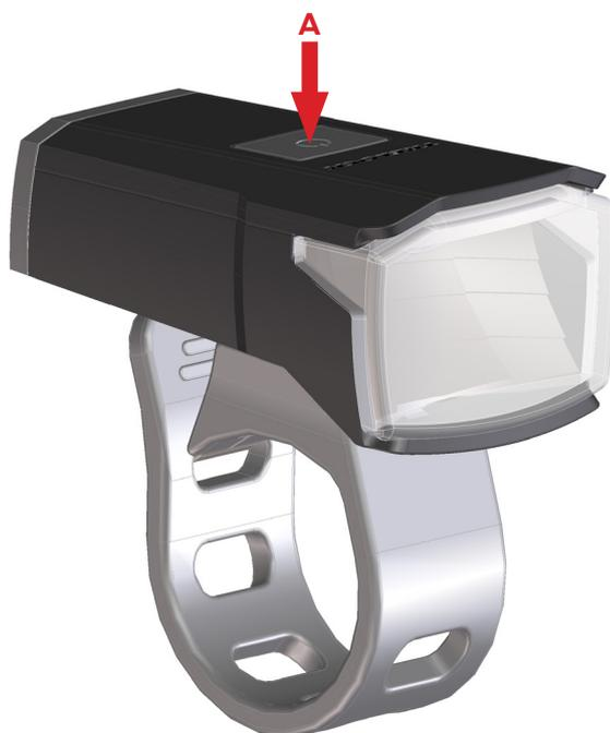
Halten Sie den Taster **A** gedrückt, um die Lampe einzuschalten. Um die 2 Beleuchtungslevel (10 Lux / 40 Lux) durchzuschalten, drücken Sie kurz auf den Taster. Halten Sie den Taster gedrückt, um die Lampe wieder auszuschalten.
