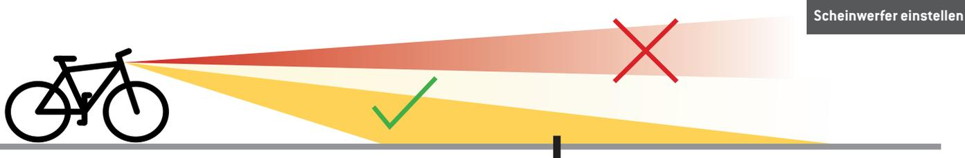
Die vertikale Einstellung des Scheinwerfers muss so erfolgen, dass andere Verkehrsteilnehmer nicht geblendet werden und das Lichtbündel in 10m Entfernung die Straße vor dem Fahrrad ausleuchtet. Schauen sie niemals direkt in das Licht.
