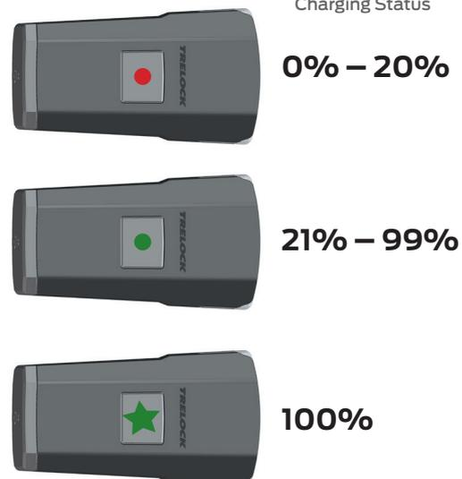
Zum Laden der Lampe die Klappe auf der Rückseite öffnen und den USB-C-Stecker in den USB-C-Anschluss einstecken. Wenn die Kontrollleuchte im Ein-/Ausshalter rot leuchtet, muss der Akku geladen werden. Während des Ladevorgangs leuchtet die Kontrollleuchte bei einem Akkustand von bis zu 20 % rot, bei einem Akkustand von über 20 % grün. Blinkt die Kontrollleuchte grün, ist der Akku vollständig geladen.
